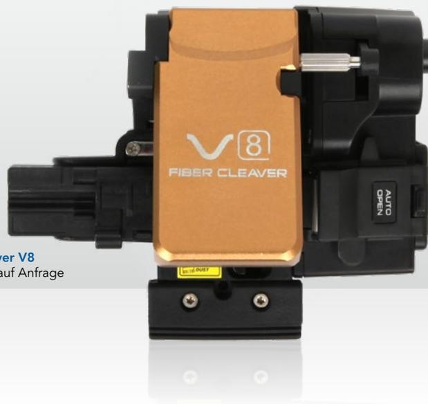
Die Cleaver V7, V7+ und V8 sind vollautomatische Brechwerkzeuge für 250 µm, 900 µm, Flachband- und 2 – 12 Faserbündchenkabel. Die vollautomatischen Brechwerkzeuge ermöglichen schnelles und exaktes Brechen der Fasern. Bei den Geräten V7+ und V8 werden die Faserreste automatisch in einem Restebehälter aufgefangen. Das V8 zeichnet dadurch aus, dass der Brechvorgang in nur einem Arbeitsschritt ausgeführt wird.
