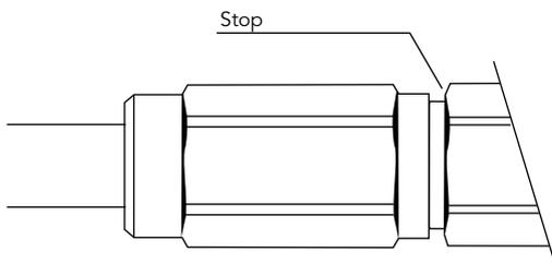
Bitte verwenden Sie zwei Maulschlüssel (weitere Informationen zu Montagewerkzeugen erhalten Sie in unserem Werkzeugkatalog). Die Ulaufmutter wird auf den Konnektorkörper bis zum Stop (Metall gegen Metall) gedreht. Halten Sie dabei immer den Konnektorkörper fest, während die Ulaufmutter geschraubt wird!
