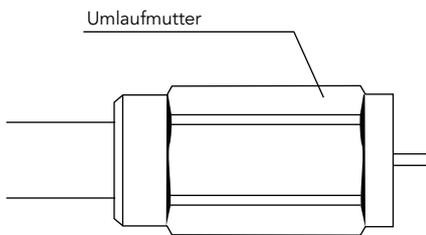
Die Ulaufmutter wird so weit wie möglich über das Kabel gezogen.
