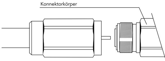
Der Konnektorkörper wird über den Innenleiter des Kabels gezogen und die Ulaufmutter handfest auf den Konnektorkörper geschraubt.
