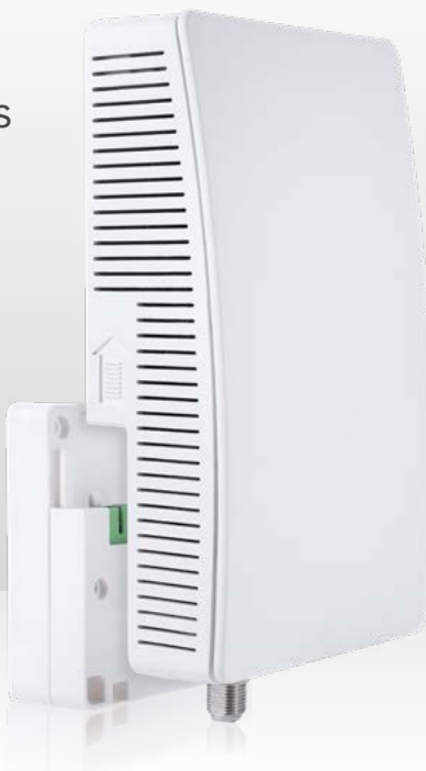
84179752 FTTH-10G-2F-3P-CATV, Abbildung mit passender FTU
